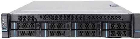
**Chipsatz: Intel C266 / Socket 1700 / Single-Prozessor-System / 12G Backplane**
